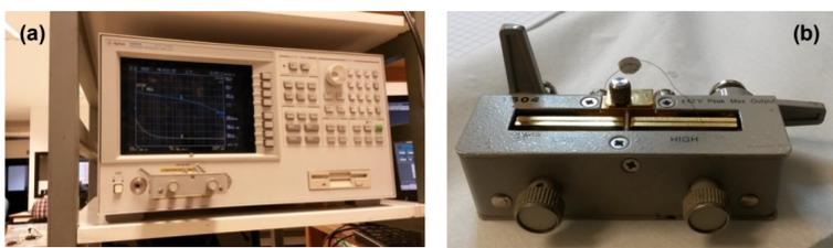
Figura 5 - Analisador de impedâncias (a) e porta-amostras com amostra (b).
