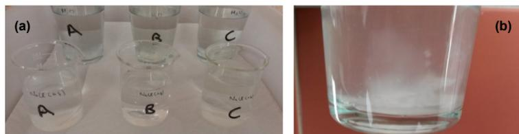
Figura 1 - Ensaio de degradação em água (a); Amostra C em água "doce" após 4 meses (b).
