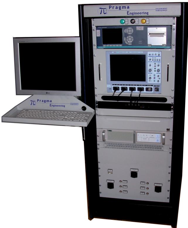
Il sistema è alloggiato in un rack mobile, che ne consente il posizionamento in prossimità dell'UPS da collaudare. Nel rack è inserita la strumentazione costituita da un PC industriale equipaggiato con uno schermo touchscreen TFT da 17", da un Wattmetro NORMA D5000 esacanale e da un gruppo di continuità asservito al sistema. Opzionalmente il sistema può essere equipaggiato con un oscilloscopio a quattro canali connesso a specifici trasduttori di tensione.
